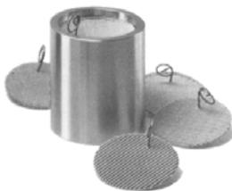
Der Staubschutz ist ein einfacher Edelstahl-Schraubzylinder (1 3/16-18 UNEF 2B) mit einem Drahtsieb am Ende. Der Staubschutz kann leicht zum Reinigen oder Austauschen des Einwegfilters abgeschraubt werden. Das Drahtsieb besteht aus Edelstahl mit einer nominalen Siebmaschengröße von 40 Micron. Dieses Zubehörteil von General Monitors wurde speziell zum Schutz der Sensorflammsperre gegen Staub und Kleinstteilchen entwickelt.
